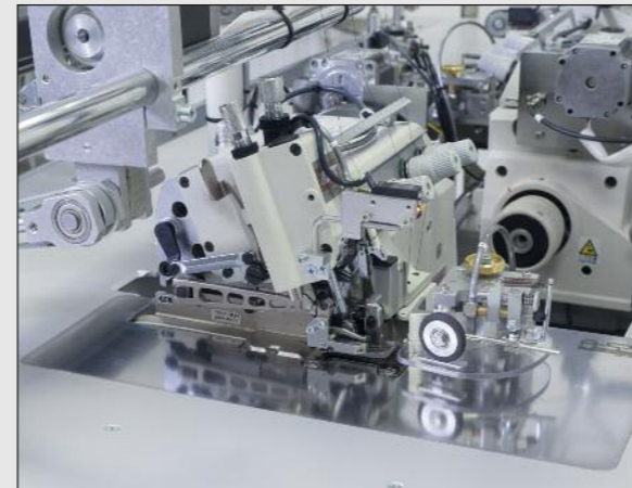
Konturenführung, Fotozelle und Nähkopf bilden eine optimale Einheit
