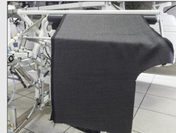
Die exakt und schnell arbeitende Staplereinheit legt die Nähteile zur weiteren Verarbeitung ab.
