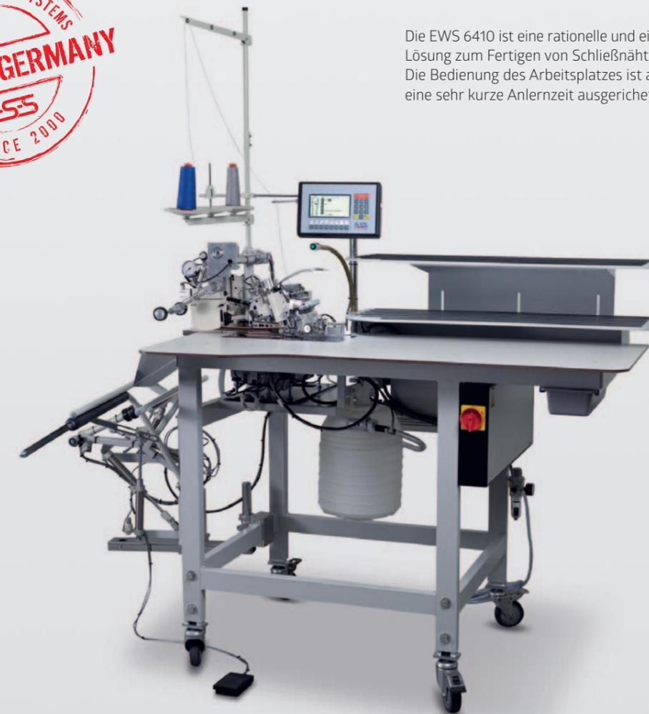
Die EWS 6410 ist eine rationelle und einfache Lösung zum Fertigen von Schließnähten. Die Bedienung des Arbeitsplatzes ist auf eine sehr kurze Anlernzeit ausgerichtet.
